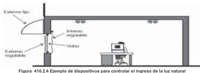
Figura 410.2.4 Ejemplo de dispositivos para controlar el ingreso de la luz natural
