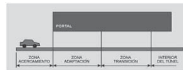
Figura 570 Zonas lumínicas de un túnel
