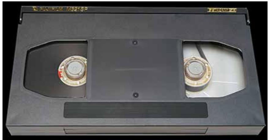
video. Tenía una gran calidad, basada en la tecnología DCT: compresión intracampo 2:1 del video por componentes con muestreo de color 4:2:2 a 10 bits, un flujo binario de 90Mb/s y 4 pistas de audio digital sin compresión PCM a 48 KHz.
