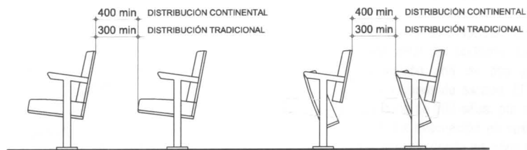
Alzado Separación mínima entre filas no abatibles y abatibles - Figura 17
